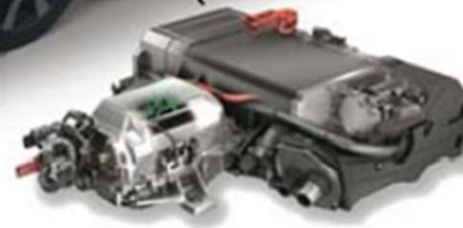
Système pile à combustible (114 kW) + convertisseur
